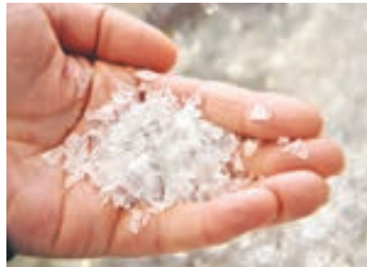
▲再処理施設に搬入後、選別、洗浄して不純物を取り除き再生工場に運ばれます。
