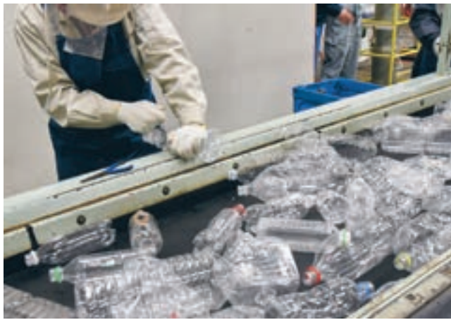
◀清掃工場に運ばれたペットボトルは、汚れや形状を確認。状態が悪いものは、手選別で除去されます。市内の福祉施設などが作業を受け持っています。
