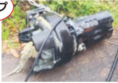
詰まったポンプの部品。タオルやオムツ、尿取りパッドなどの布状のものが詰まっている。
