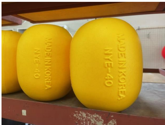
写真3 韓国製のPVフロート
