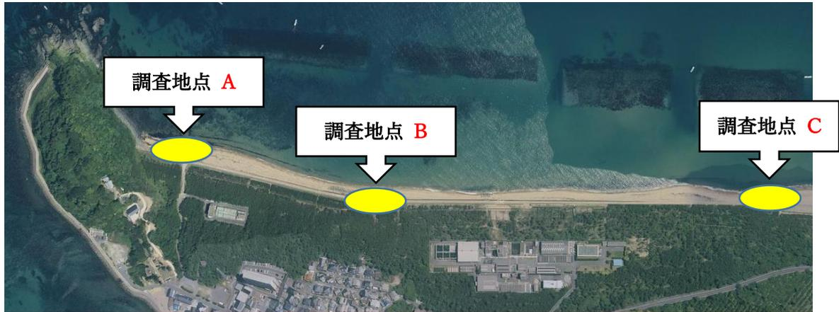
**調査地点 A** 礫浜から砂浜へ変化する場所を左起点とした幅 30m
