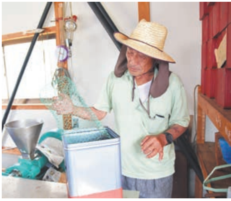
平成9年に建て替えられた2代目の加工所。搾圧は中村進一さんがお世話をしている。左手奥に見えるのが搾圧機。福岡県に数台しか無いため、市外からの依頼もあるとか。右手の網カゴの中に地島オリジナルのろ過紙をセットし、ゆっくり、ゆっくり、時間をかけ椿油をろ過する。
