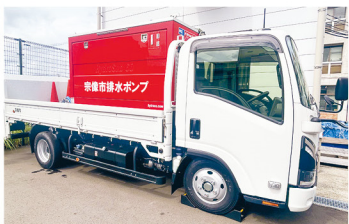
移動式排水ポンプ車
