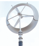
風レンズ風車 (提供：九州大学 応用力学研究所)
