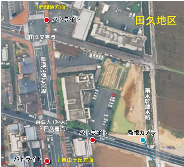
梅雨や台風などの大雨時に、県道宗像若宮線の東海大（短大）入口交差点付近の道路上が冠水するため、通行車両などへの周知を目的に、水位監視カメラと注意喚起用パトライトを設置しました。パトライトは、雨水幹線水路の一番高い所から下5
